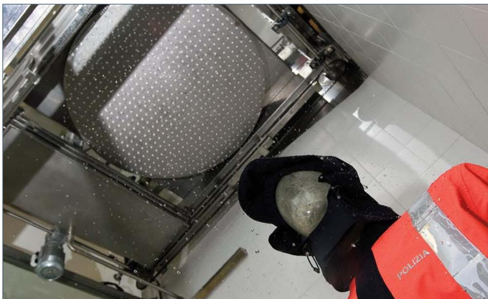
Este dispositivo prueba la resistencia a distintos tipos de lluvia y vientos laterales de un chaquetón para la Ertzaintza.
