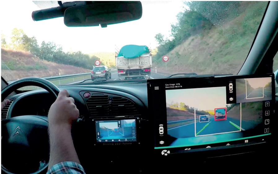
El sistema de asistencia a la conducción de Xesol incorpora cámaras para monitorizar el entorno.
