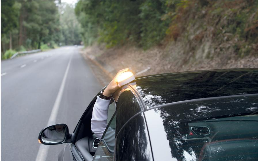
El dispositivo permite señalar la avería o accidente de forma rápida y sin salir del vehículo.
